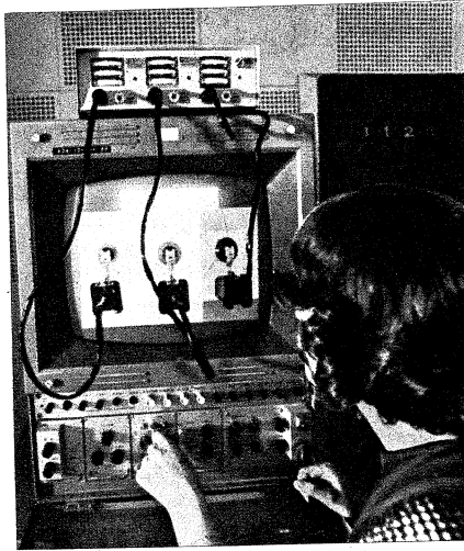
Bild 1. Mit Hilfe fotoelektrischer Sensibilatoren werden aus dem Referenzweiß die Intensitätsanteile der drei Farbauszüge ermittelt
